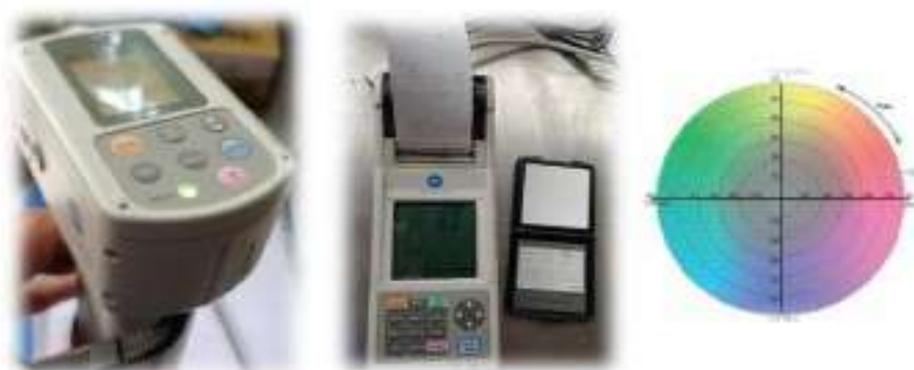
**Foto 1:** spettrometro CM-2600d e relative misure; a destra è possibile visualizzare l'interpretazione del colore in base alle coordinate L\*a\*b\* nello spazio colore.
